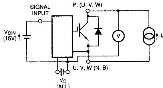
Figure 3  $V_{EC}$  Test
